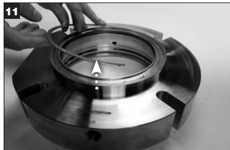
11 Uszczelki z zestawem tulei: Wyjąć stacjonarny pierścień sprężynujący z dławika i wyrzucić.
