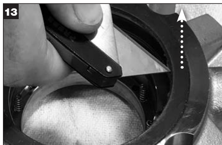
13 Wyjąć uszczelkę komory dławnicowej z dławika i wyrzucić.
